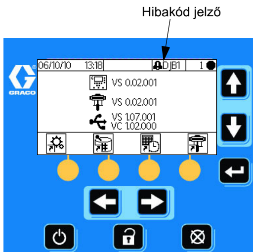
53. ábra: Riasztási kódok a kijelzőmodulon
